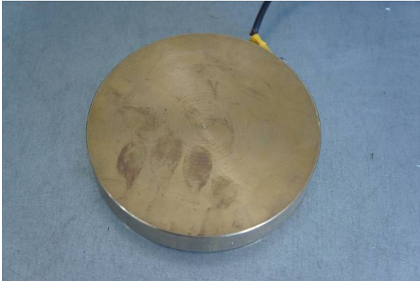
Elettrodo circolare in ottone con PET-PU conduttivo applicato
