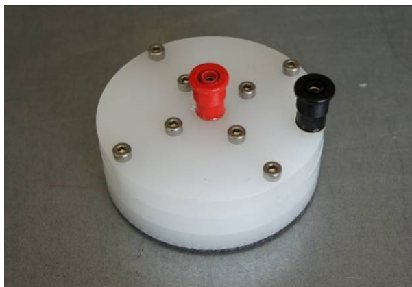
Elettrodi coassiali in materiale plastico con PET-PU conduttivo applicato
