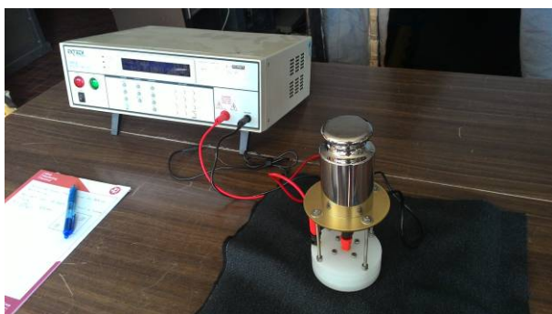
Prova di resistività superficiale
